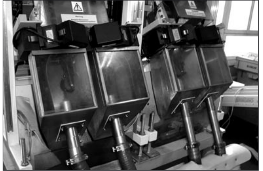
Die Qualität jeder Bohne wird einzeln mit der «Sortex»-Maschine geprüft (Bild zvg)
